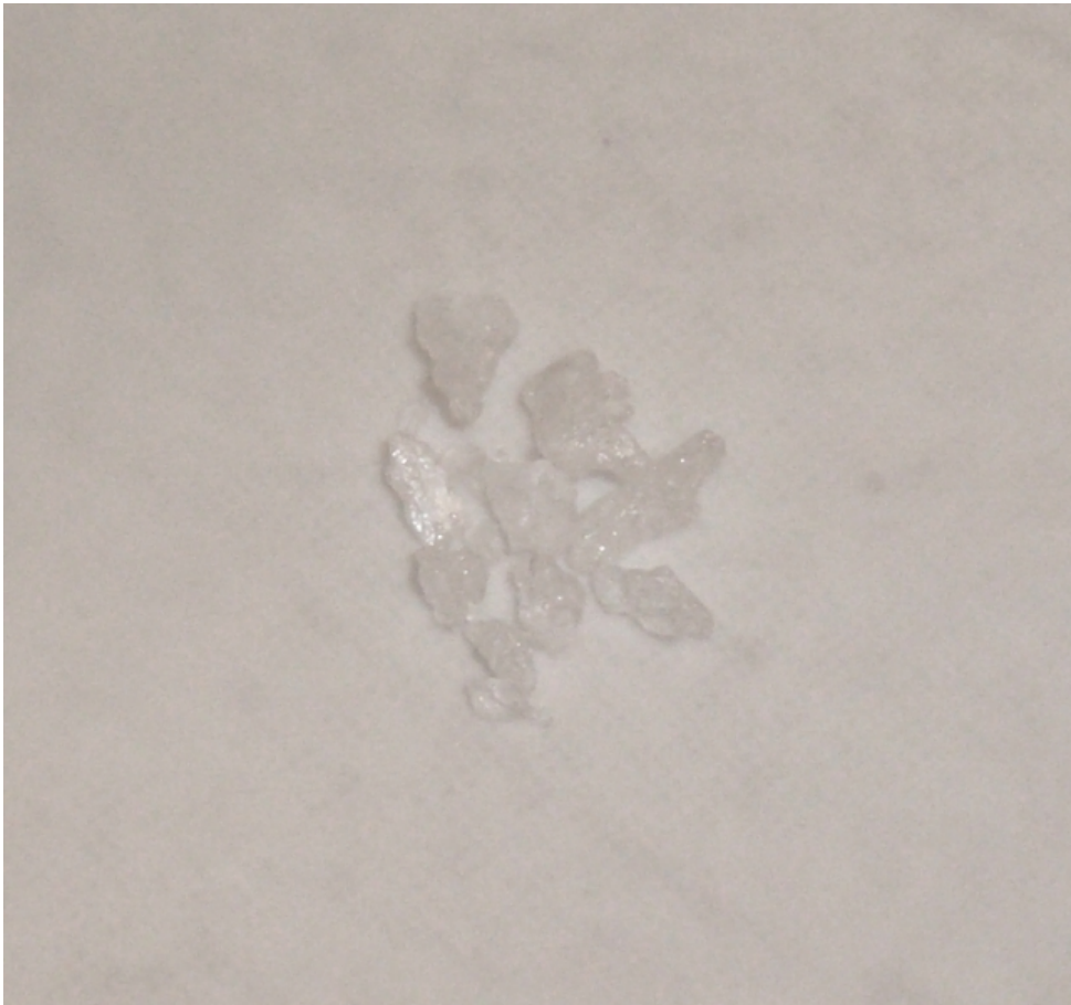
Kristalle von Xenondifluorid (auf PTFE-Folie)
