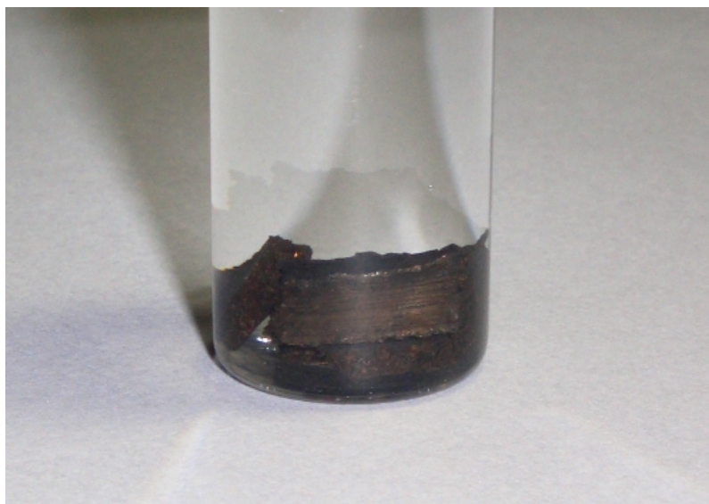
Metallisches (abgereichertes) Uran
