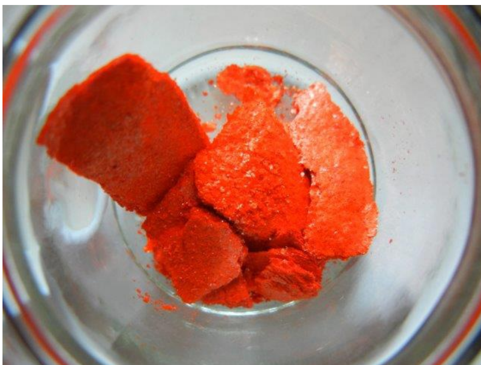
Nach dem Filtrieren gewaschenes, ausgepresstes und getrocknetes \text{Ru}(\text{bipy})_3\text{Cl}_2 \cdot 6 \text{H}_2\text{O}
