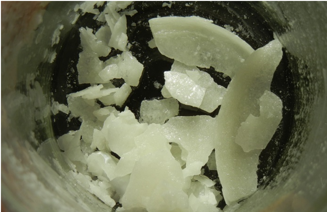
Rohprodukt (vor dem Schmelzen, um Ethanolreste zu entfernen)
