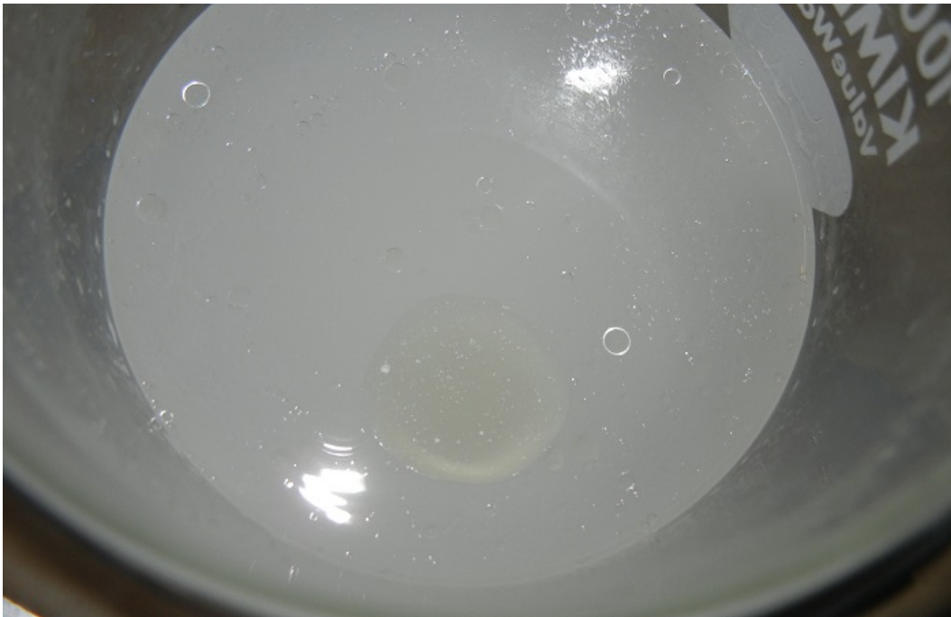
Beim Abdampfen von Ethanol sich bildende Tropfen aus Ethanol mit gelöstem \text{Ph}_3\text{PO}
