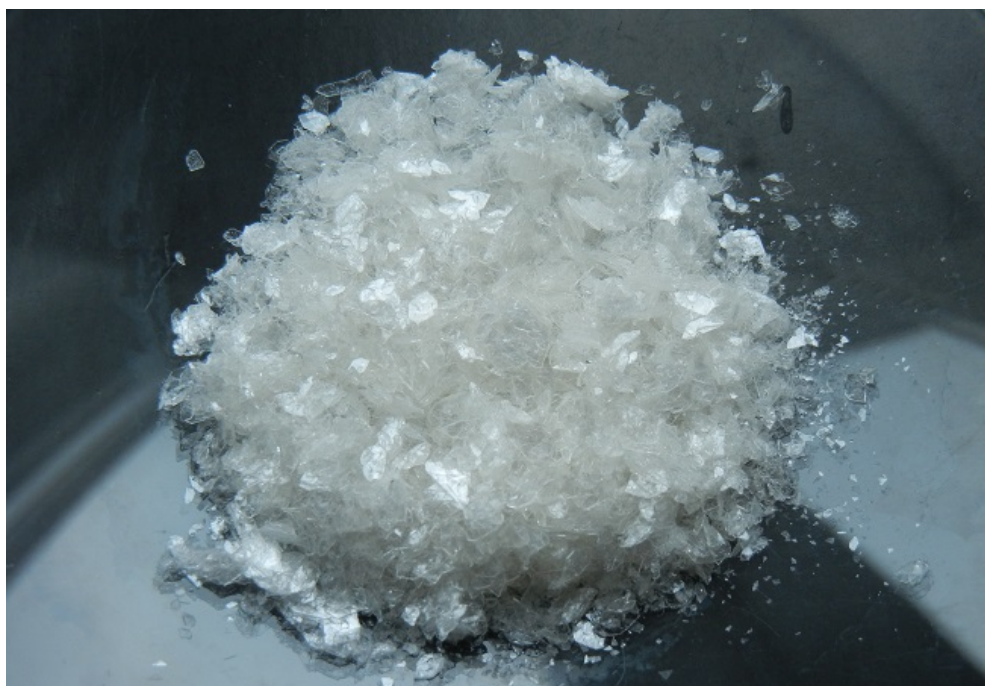
Größere Kristalle entstanden aus einer Mischung von Feuerzeugbenzin und Aceton (4:1), hier etwa 3,5 g.
