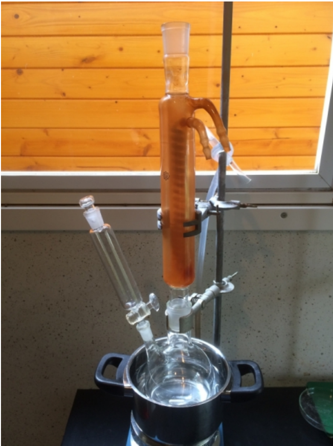
Der Aufbau noch ohne Reaktanden und Kühlung vor der Überführung unter den Abzug
