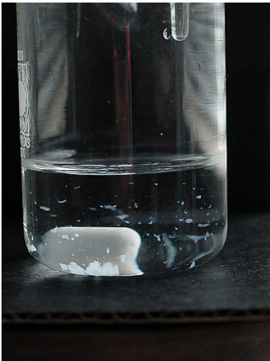
Titration ohne Zusätze - Ausfallen flockigen Silbercyanids
