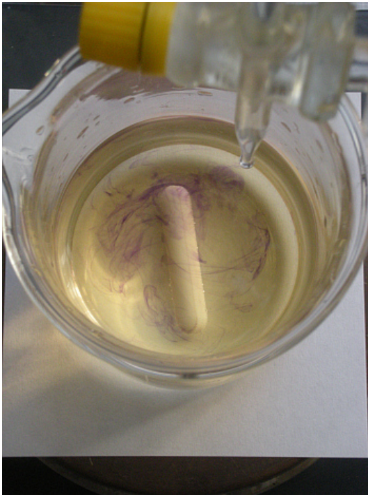
Schlierenbildung während der Titration
