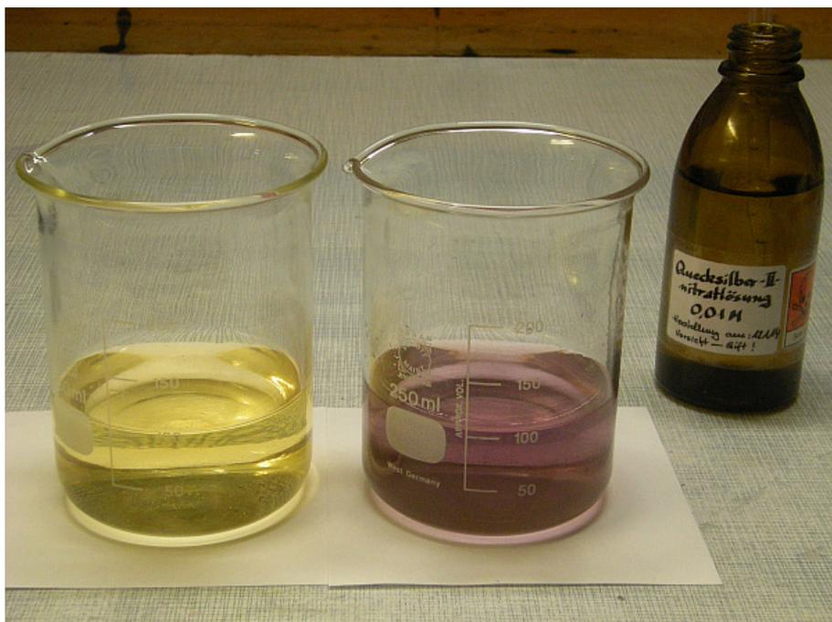
Färbung des Indikators in angesäuertem Aqua dest. (links) und nach Zugabe von 0,075 ml Quecksilbernitratlösung 0,01 M (rechts)
