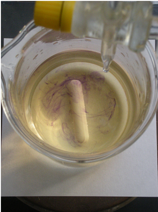
Schlierenbildung während der Titration
