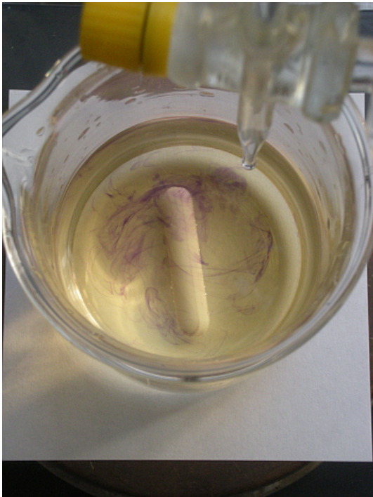
Schlierenbildung während der Titration
