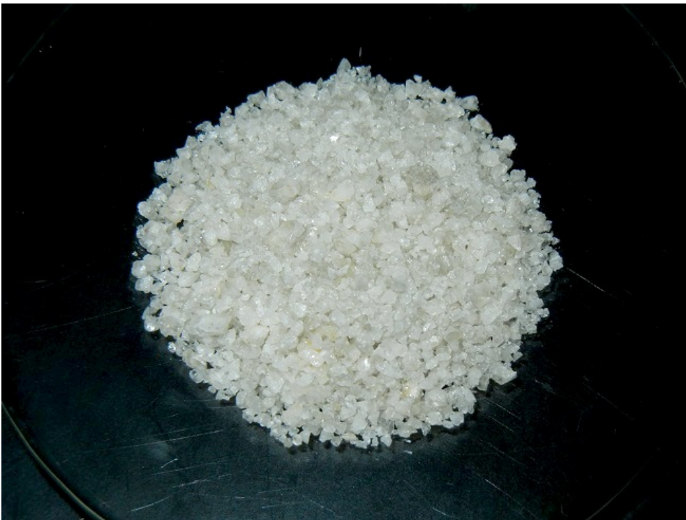
gewonnene Kristalle von \text{Tb}_2(\text{SO}_4)_3 \cdot 8 \text{H}_2\text{O}
