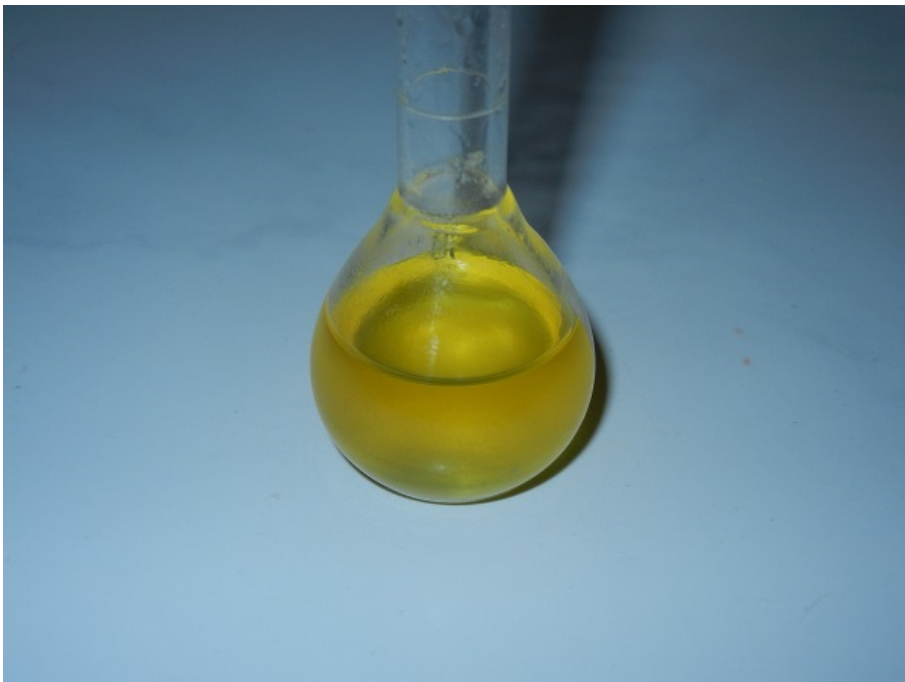
Lösung von Lophin in ethanolischer KOH-Lösung. Lophin löst sich darin ziemlich gut.
