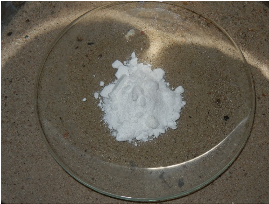
Hydrobenzamid auf Uhrglas im Sandbad (Alternative zum Erhitzen im Erlenmeyer, jedoch mit großer Rauchentwicklung)
