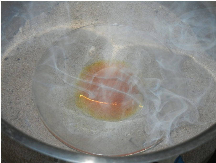
Zersetzung des Hydrobenzamids bei bereits hoher Temperatur
