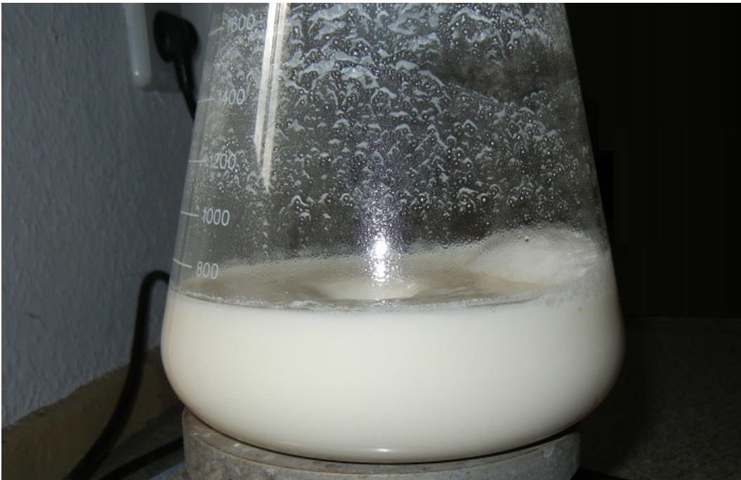
Rühren und kurzzeitiges Erhitzen bis zum Sieden
