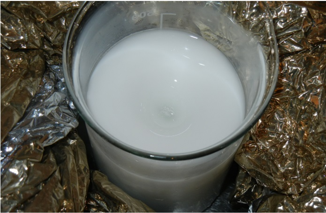
Kurz nach Zugabe des gesamten Bariumbromats zur Schwefelsäure
