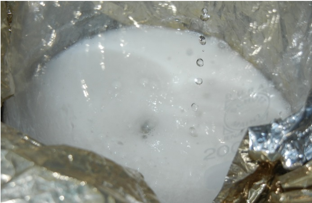
Zutropfen der Bromsäure zur Strontiumcarbonat-Suspension
