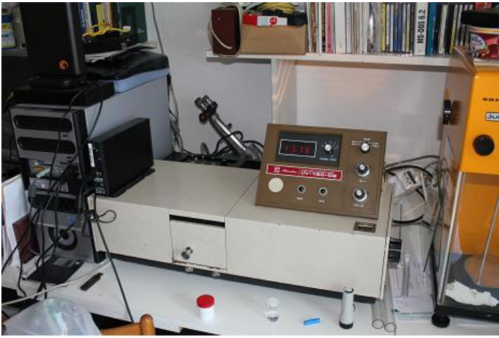
Das Arbeitsgerät - Zweistrahlenspektrophotometer von Shimadzu mit Wolfram- und Deuteriumlampe
