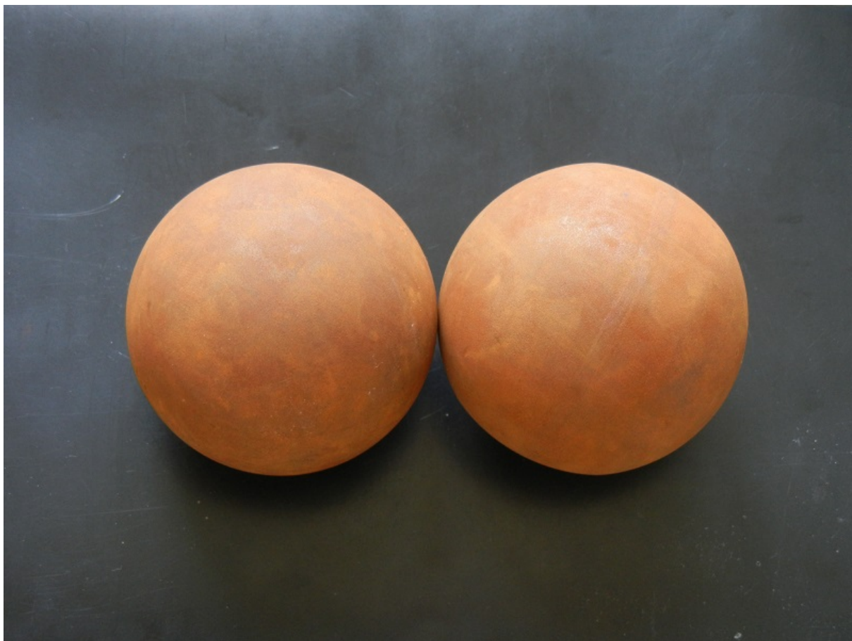
noch nicht ausreichend (weil nur dünn) verrostete Kugeln
