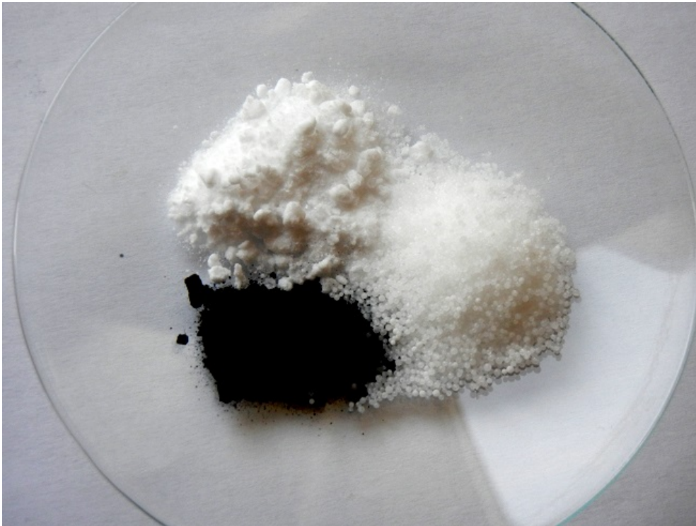
Die Edukte für den Oxidationsaufschluss
