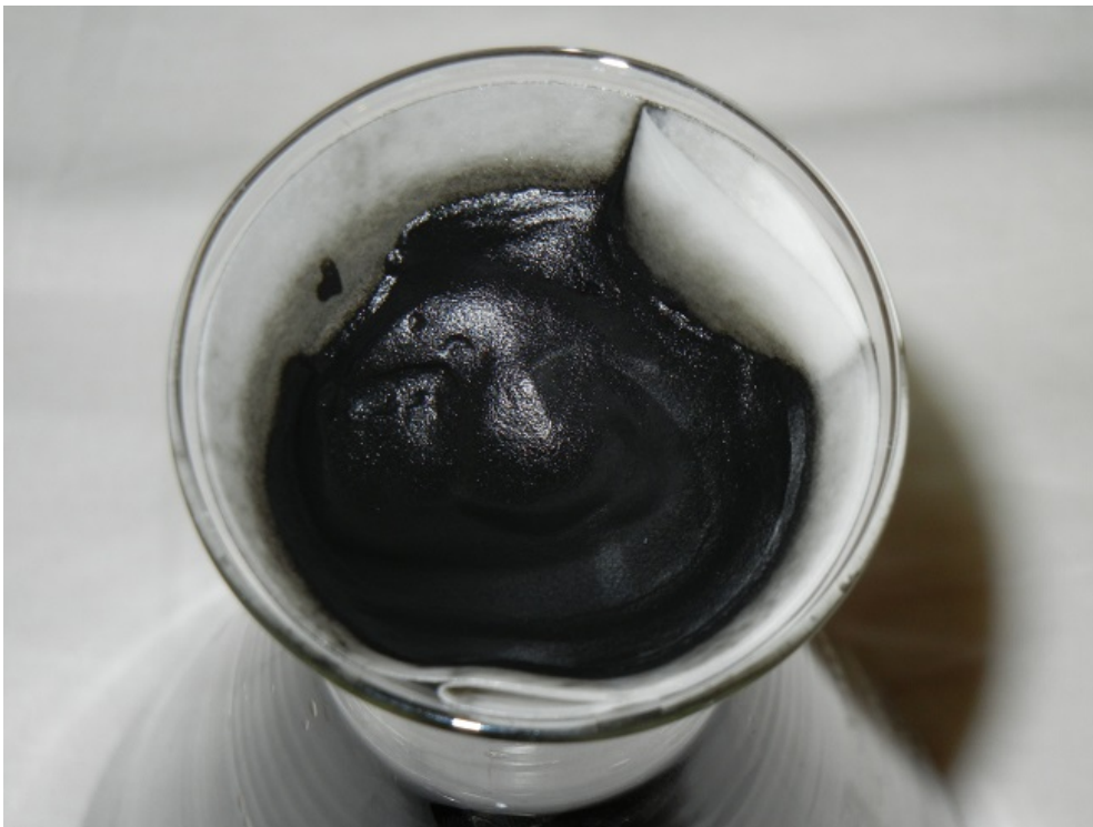
abfiltriertes hydratisiertes Rutheniumdioxid
