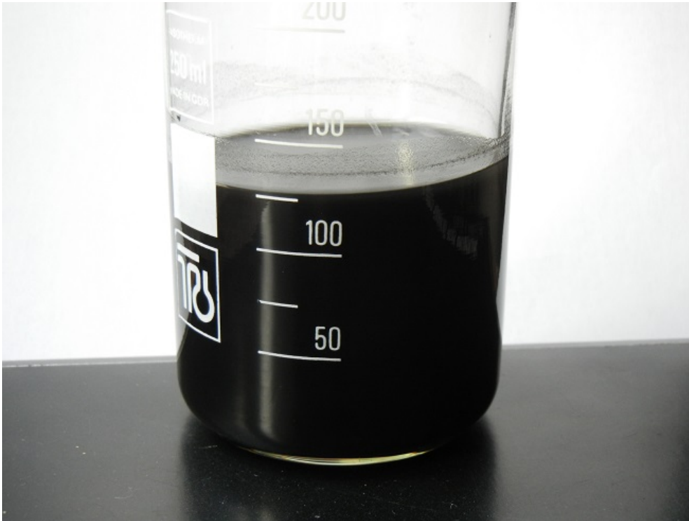
RuO 2 -Suspension nach Fälln mit Ethanol
