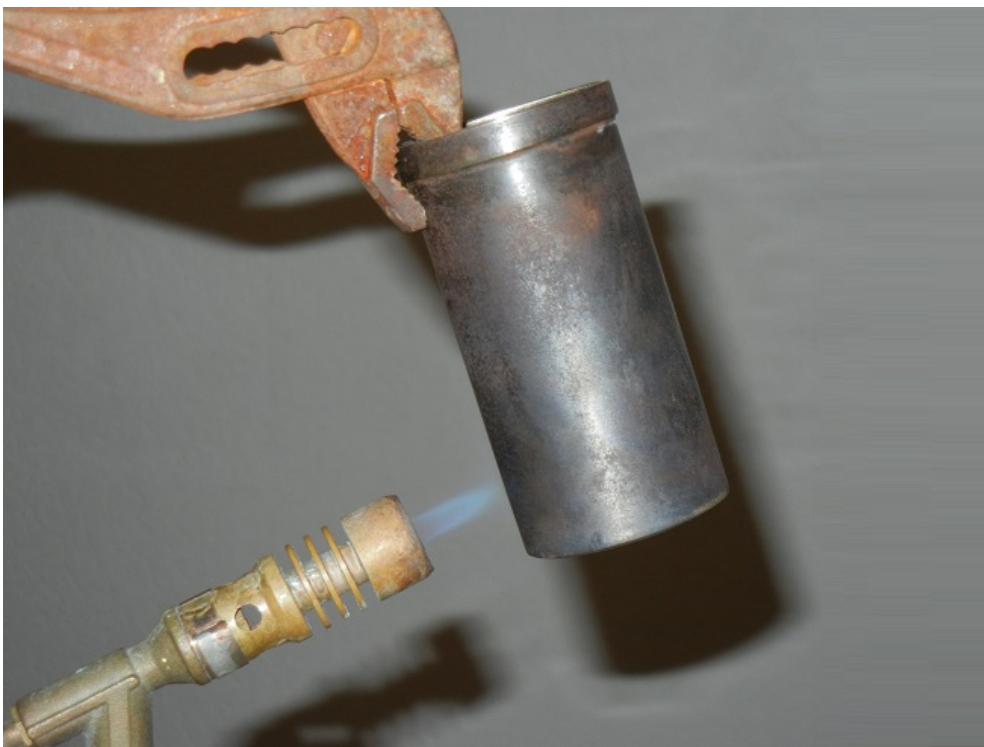
Aufschluss im Eisentiegel
