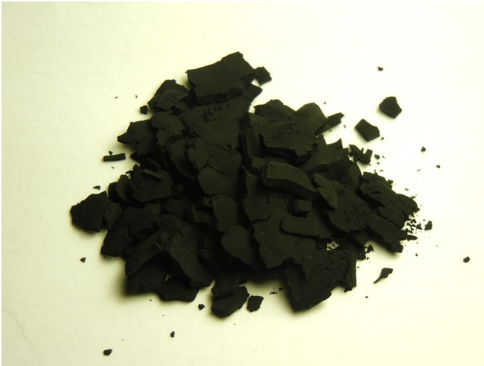
getrocknetes \text{RuO}_2 \cdot x \text{H}_2\text{O}
