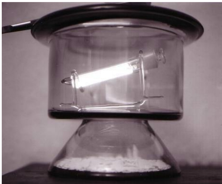
Das 1933 von O. Hönigschmidt zur Atomgewichtsbestimmung aus einer Belgischen Lieferung rohen Radiumbromids dargestellte Reinpräparat, entsprechend 3 g elementarem Radium. Das Präparat strahlt so stark, dass es in seinem eigenen Licht fotografiert wurde. Die zur Aufbewahrung verwendeten Glasgefäße verfärbten sich binnen weniger Wochen braunviolett. (Bild aus dem deutschen Museum München, entnommen aus ChiuZ 15 (1981): S. 167)
