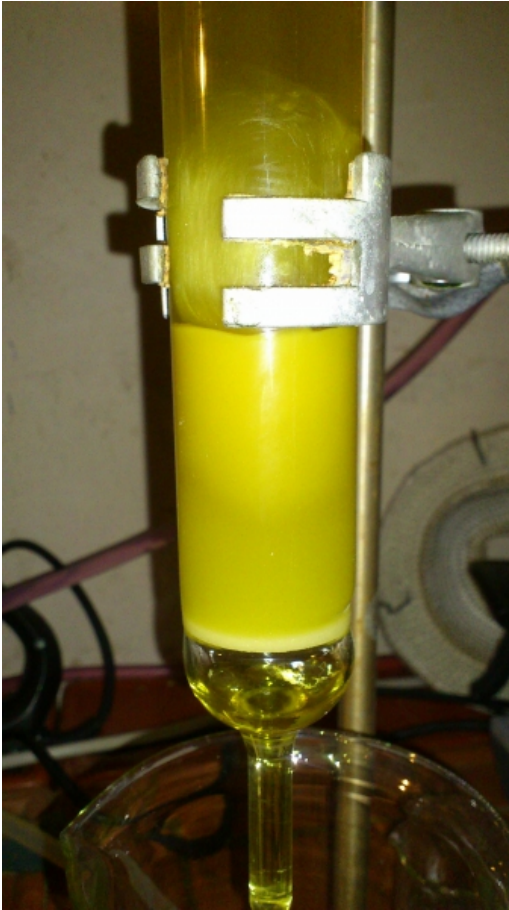
Kieselgelpad (man erkennt in der oberen Hälfte die zurückgehaltenen Begleitstoffe)
