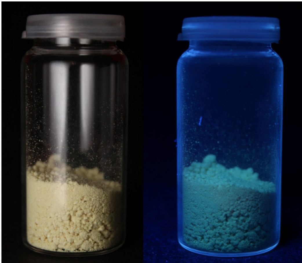
Isoliertes Produkt unter Normal- und UV-Licht (366 nm, Fluoreszenzfarbe nicht korrigiert)
