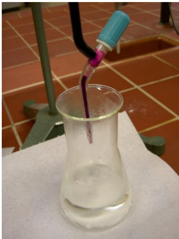
Einstellung der Permanganatlösung
