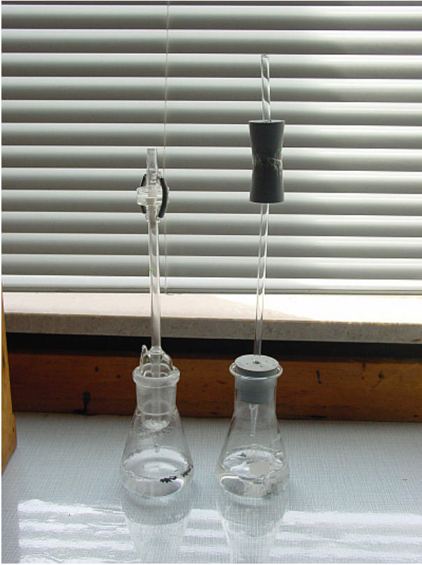
Geräte zum Arsennachweis, links Arzneibuchapparatur, rechts Eigenbau
