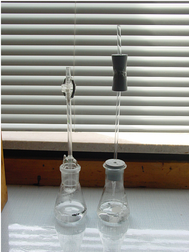
Geräte zum Arsennachweis, links Arzneibuchapparatur, rechts Eigenbau
