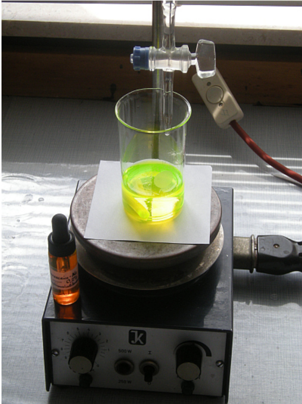
Titration, Analysenlösung mit Fluorescein versetzt
