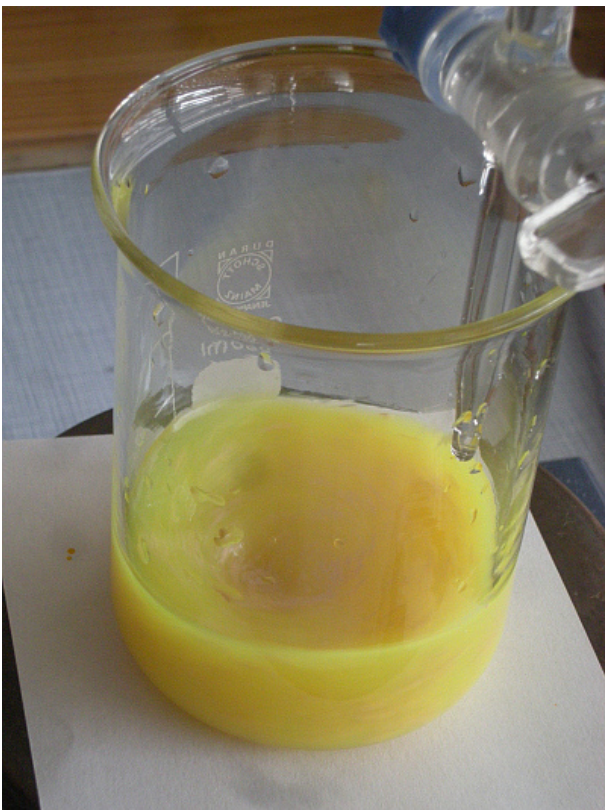
Endpunkt der Titration: Rosafarbener Niederschlag in gelber Flüssigkeit, die dadurch bräunlich erscheint
