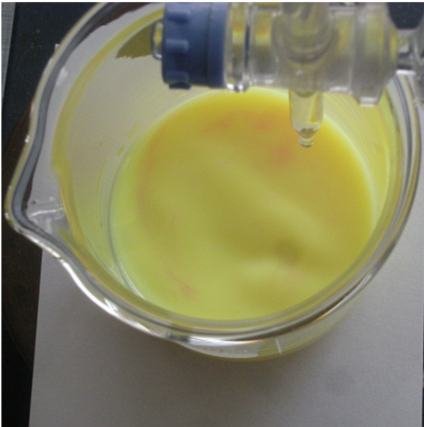
Titrationbeginn, Schlierenbildung beim Zutropfen der Silbernitratlösung
