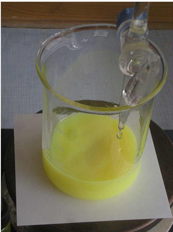
Titration, Analysenlösung mit Fluorescein versetzt
