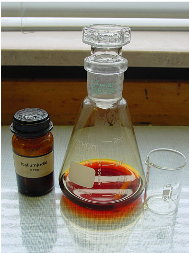
Nach Zugabe von Kaliumjodid: Ausscheidung von Iod
