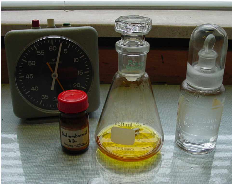
Analysensubstanz mit Kaliumbromid und Salzsäure versetzt: Bildung von Brom
