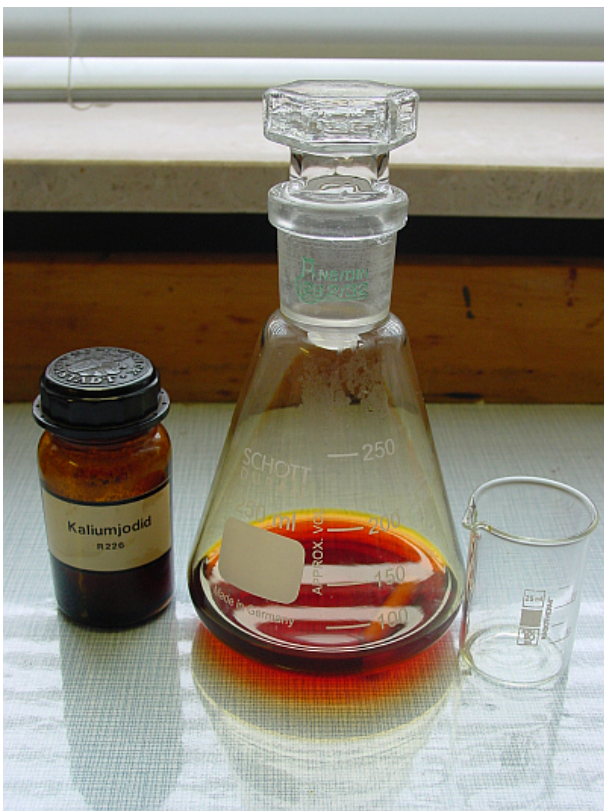
Nach Zugabe von Kaliumjodid: Ausscheidung von Iod
