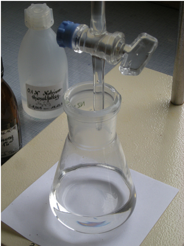
Titration mit Natriumthiosulfatlösung
