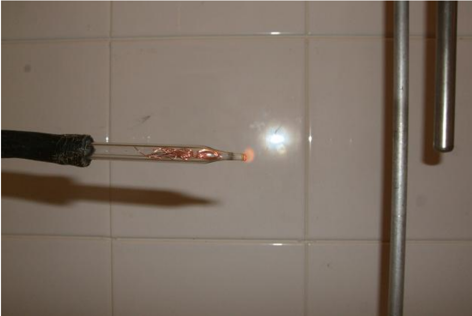
Flamme des abbrennenden Wasserstoffs, Rückschlagsicherung aus Cu-Draht, ebenfalls gut erkennbare Arsenabscheidung an der Glasinnenseite der Pipettenspitze
