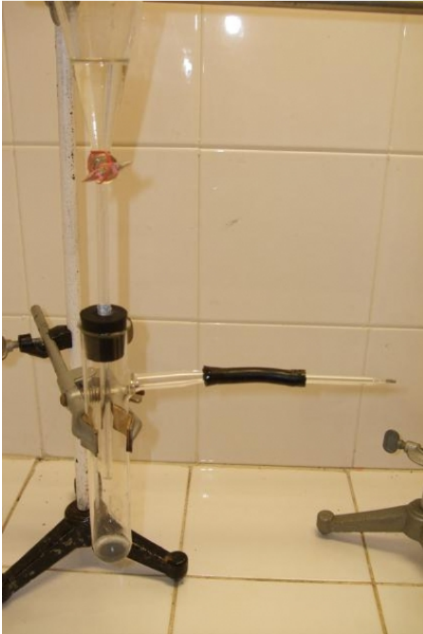
Der Versuchsaufbau (hier noch ohne Rückschlagsicherung in der Pipettenspitze)
