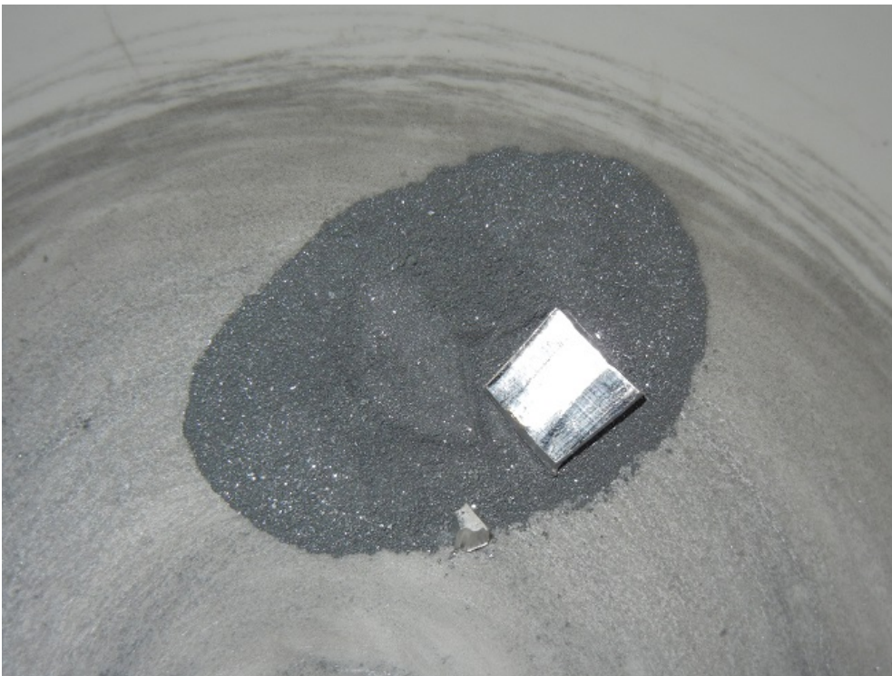
Indiumstück im Mörser zusammen mit dem Antimonpulver
