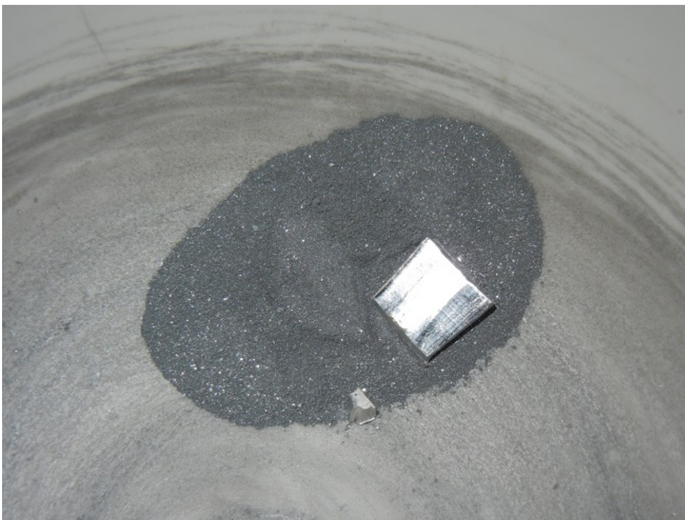
Indiumstück im Mörser zusammen mit dem Antimonpulver
