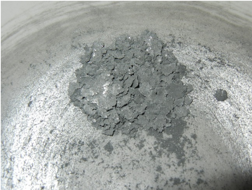
„Flakes“ aus Indium mit eingepresstem Antimonpulver
