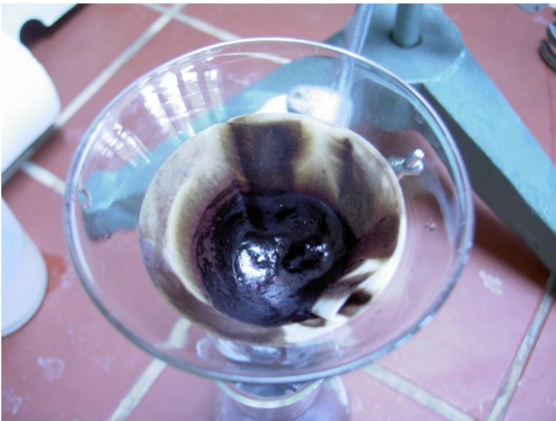
Filtration; Indigo als brauner Schlamm an den Seiten erkennbar
