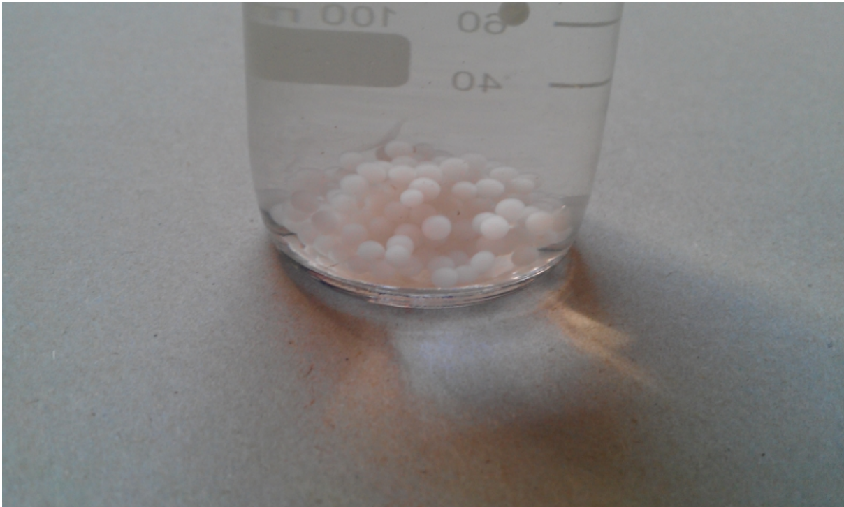
Trägerfixierte Hefe in Form kleiner Kugeln
