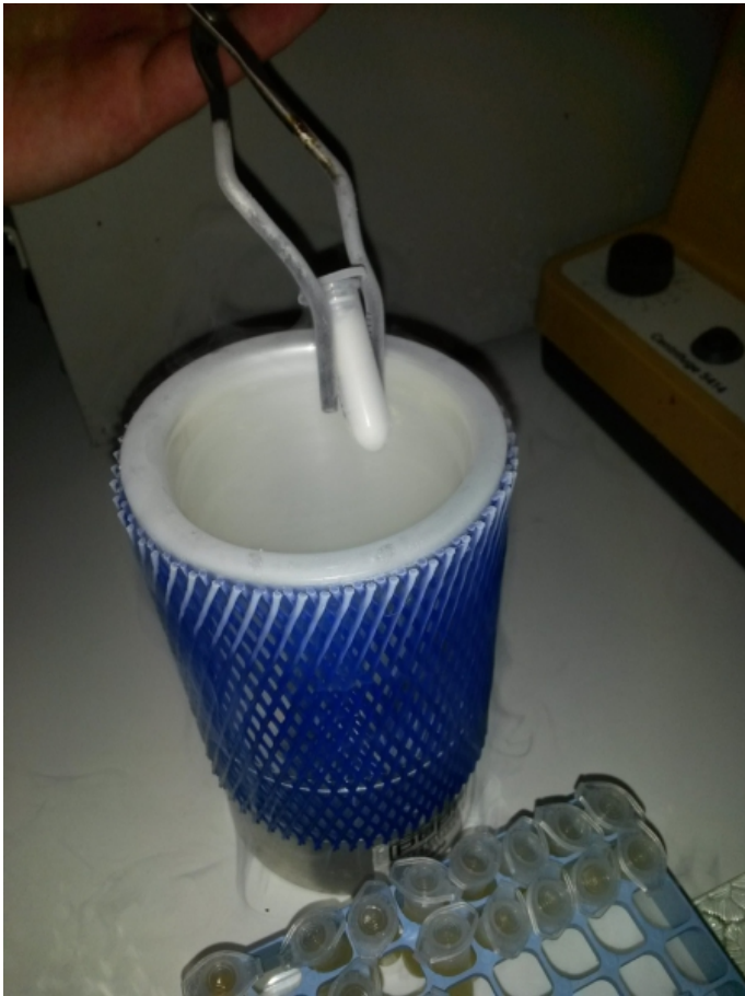
Schockgefrieren mit Stickstoff.
