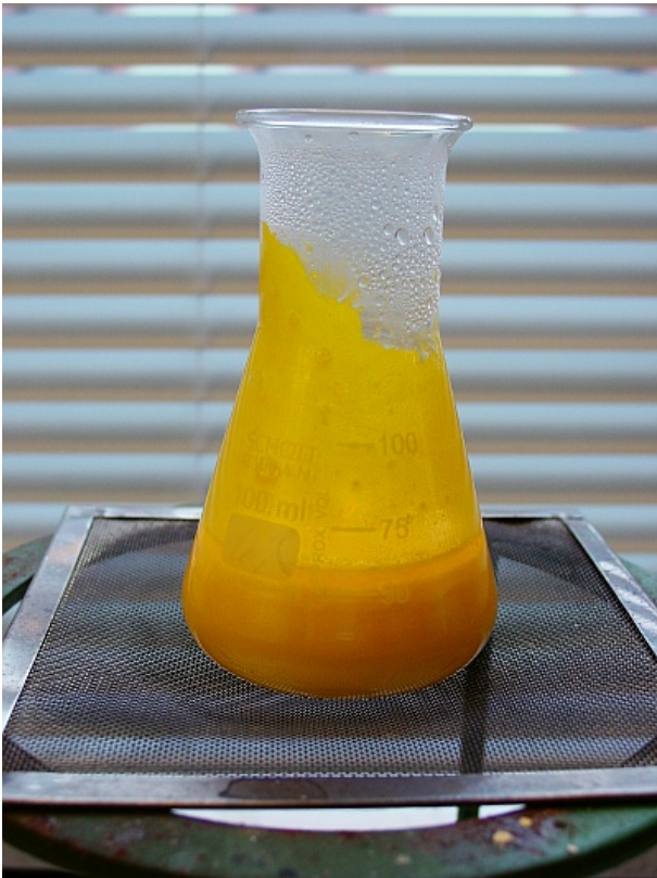
Der Blei(II)-iodid-Niederschlag vor der Filtration
