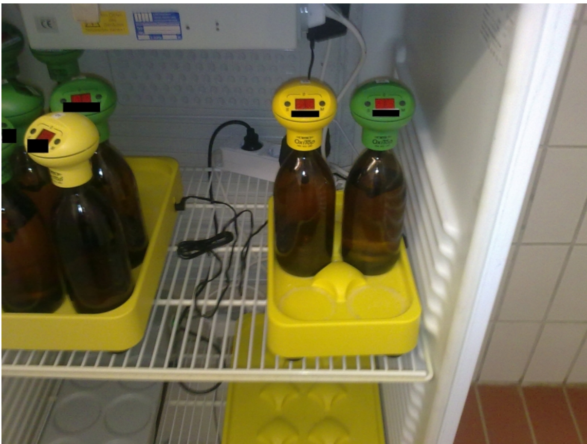
Thermoschrank mit Rührplättchen gewährleistet genaue und gleichbleibende Messergebnisse.
