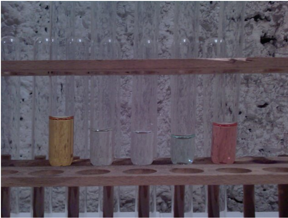
Prüflösungen, von links nach rechts: \text{Fe}^{3+} , \text{Fe}^{2+} , \text{Zn}^{2+} , \text{Ni}^{2+} , \text{Co}^{2+}
