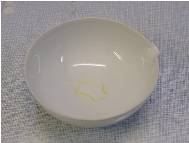
Verdampfungsrückstand mit 300 µg Atropinsulfat
