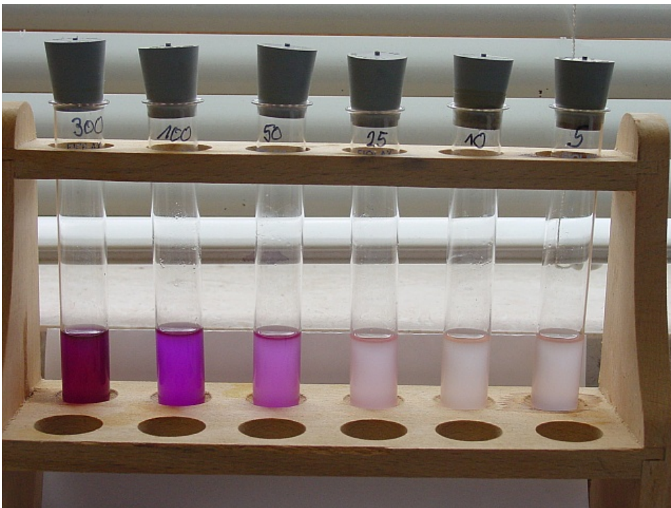
Farbintensität mit fallenden Mengen Atropinsulfat
