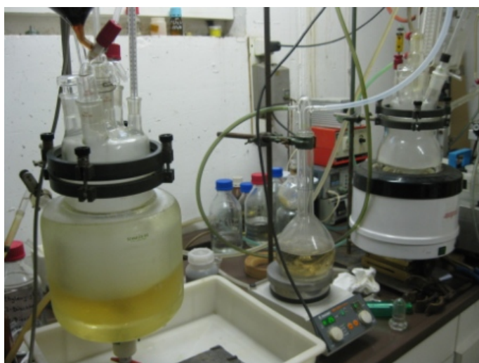
Das HCl wird auf dem Magnetrührer in Schwefelsäure getrocknet und in einen anderen Reaktor eingeleitet.
