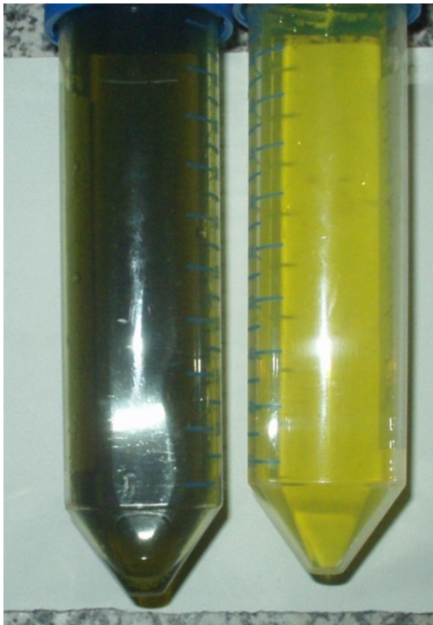
Links: 25% Ammonium Eisen(III)citrat Lösung; Rechts: 10% Lösung von rotem Blutlaugensalz (Beide in Wasser)
