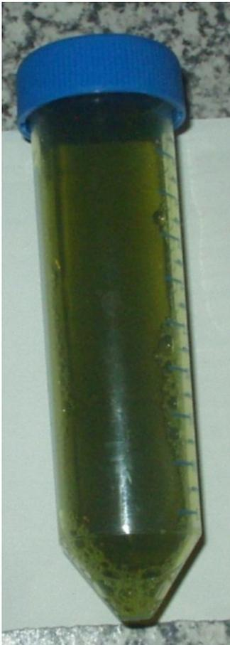
Lichtempfindliche Lösung; hergestellt aus einer Mischung von gleichen Teilen A und B mit 2 Tropfen Tween20
