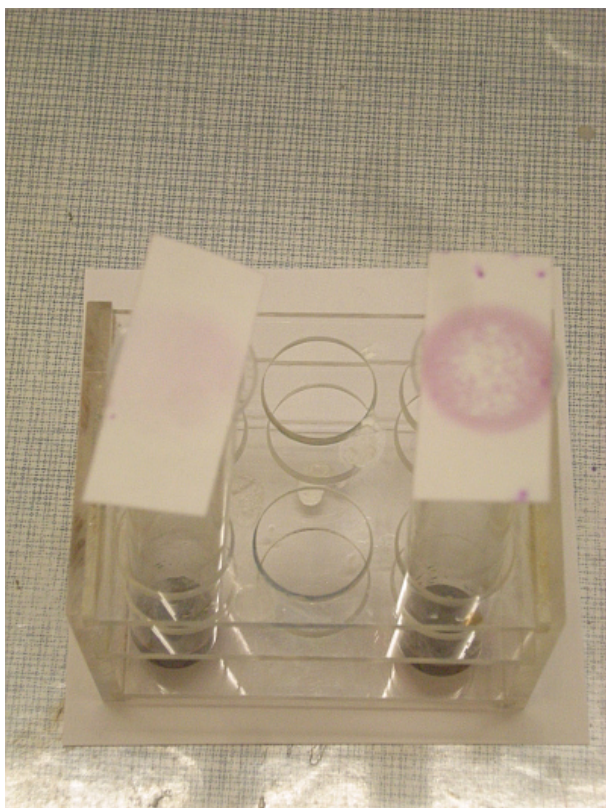
Chromylchloridreaktion mit 2 mg (links) und 5 mg (rechts) Natriumchlorid
