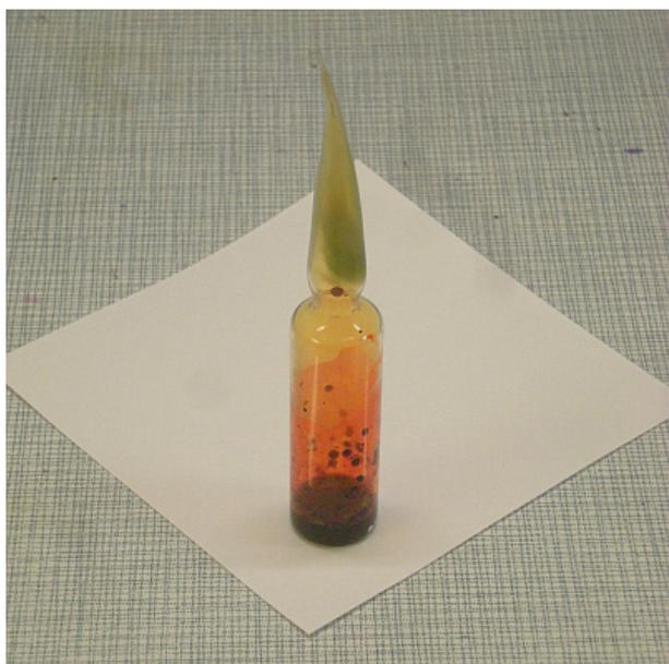
Ampulle mit eingeschmolzenem Produkt. Offenbar ist Feuchtigkeit eingedrungen, denn es haben sich Kristalle von Chrom-VI-oxid an der Ampullenwandung abgeschieden
