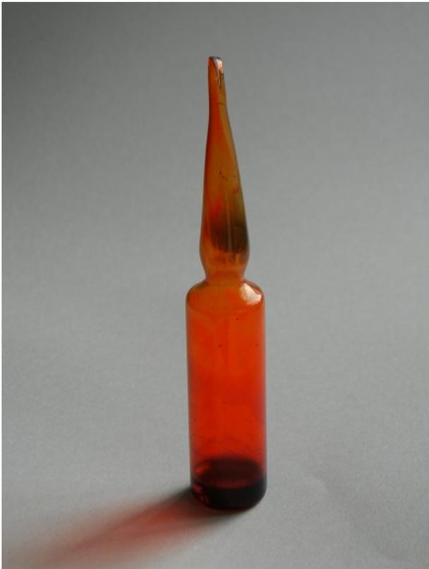
Ein zweites Präparat, das unter weitgehendem Ausschluss von Feuchtigkeit eingeschmolzen wurde. Am Ampullenhals bildet sich durch thermische Zersetzung beim Abschmelzen etwas grünes Chrom(III)-oxid
