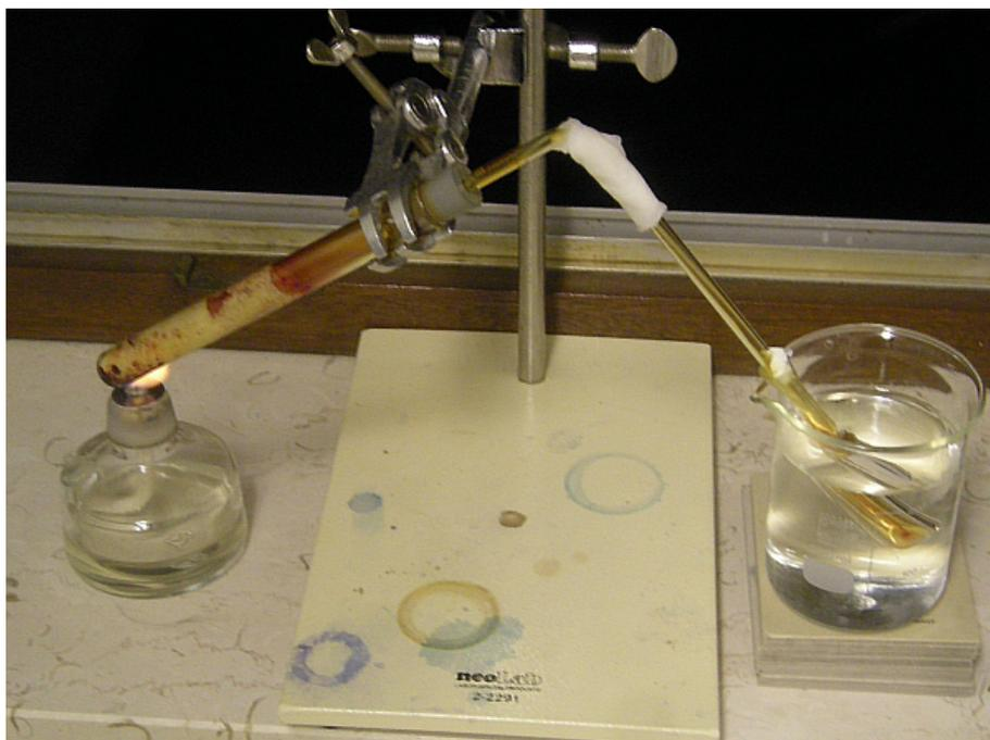
Darstellung von Chromylchlorid (das hier abgebildete Kühlen des Glasrohres durch feuchtes Fließpapier sollte man *unterlassen*, damit keine Feuchtigkeit ins Produkt gelangt. Luftkühlung ist ausreichend).
