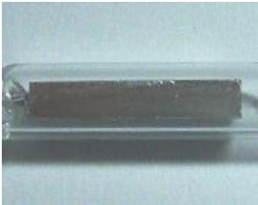
Cadmiumbarren und "Klotz" ca.120g Gesamtmasse (Bild von Newclears)
