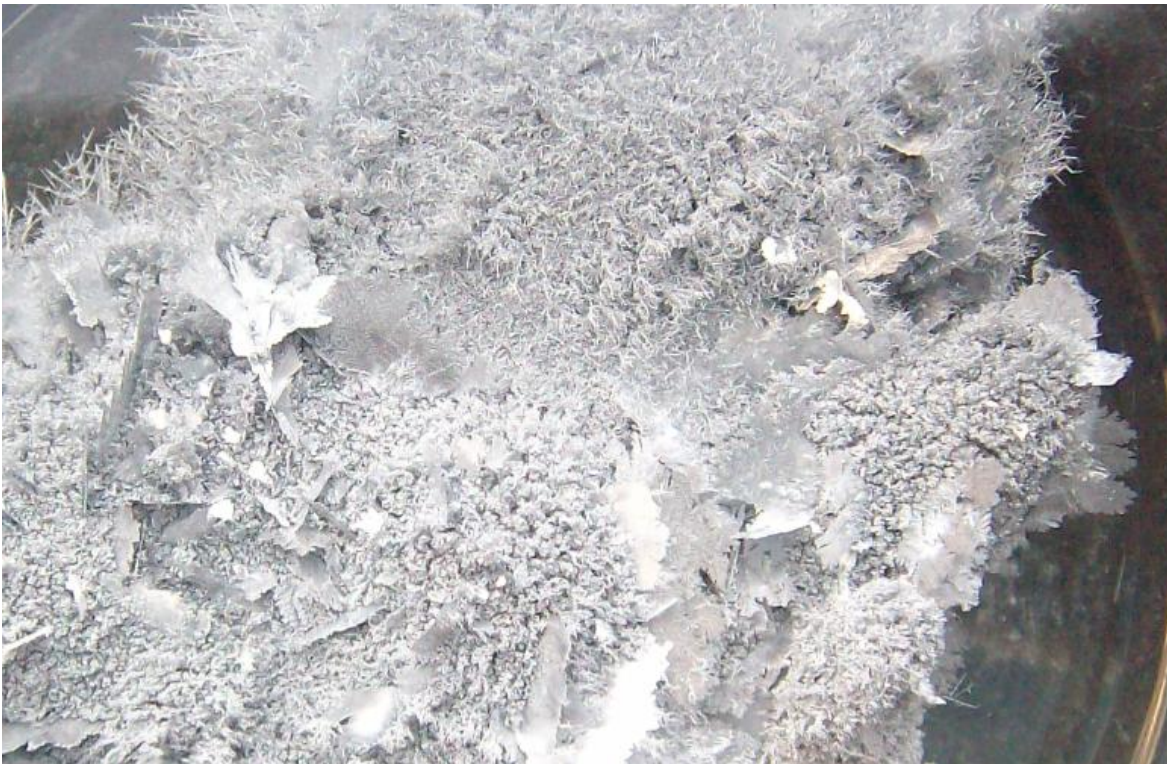
Cadmiumschwamm dendritisch und grobkristallin aus einer Cadmiumsulfatlösung auf Zink aufgewachsen (Bild von Newclears)
