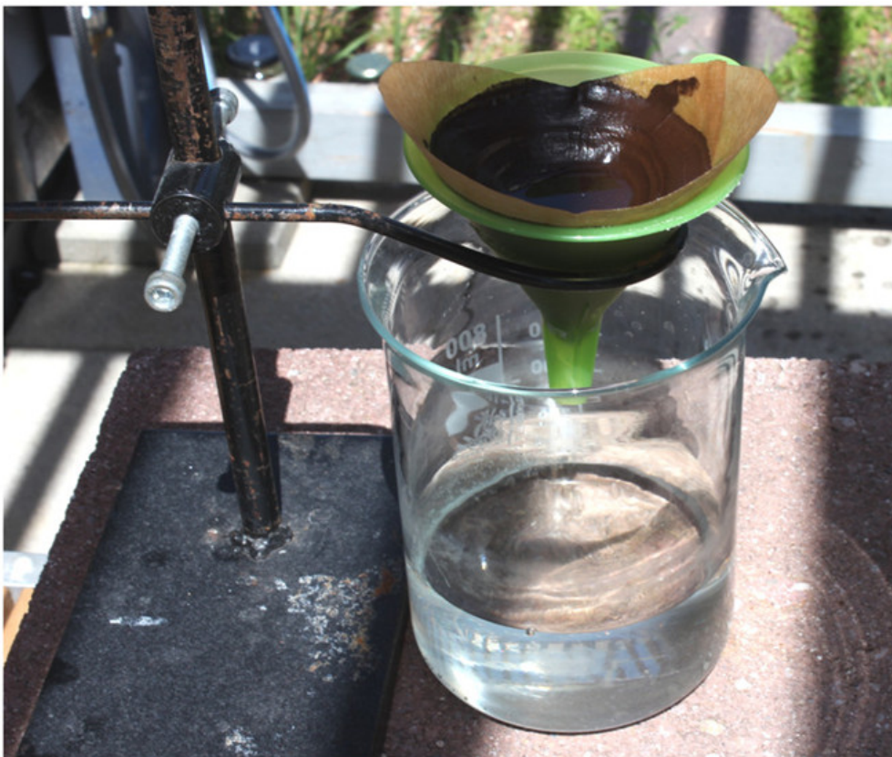
Entfernen von Mangandioxid durch Filtration
