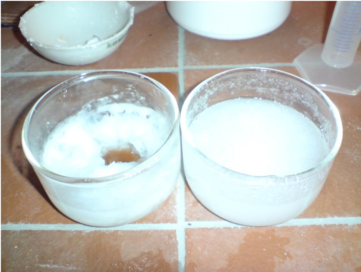
Nach der Zugabe des Alkohols, links Ethanol und rechts Methanol
