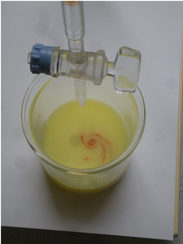
Titration, an der Eintropfstelle Schlieren von Silberchromat
