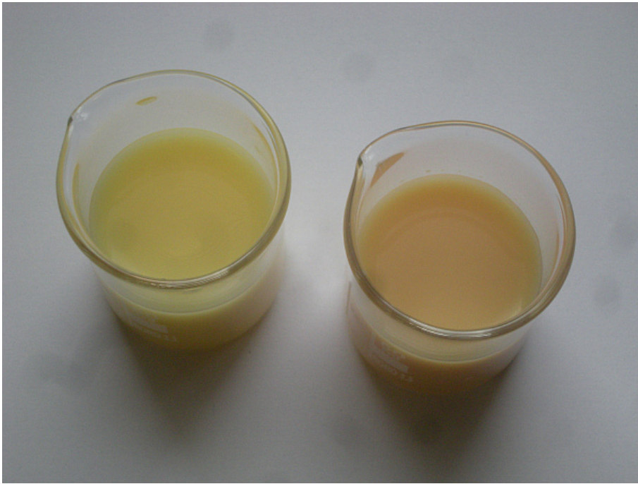
Farbe der Titrationsmischung vor und am Endpunkt im Vergleich
