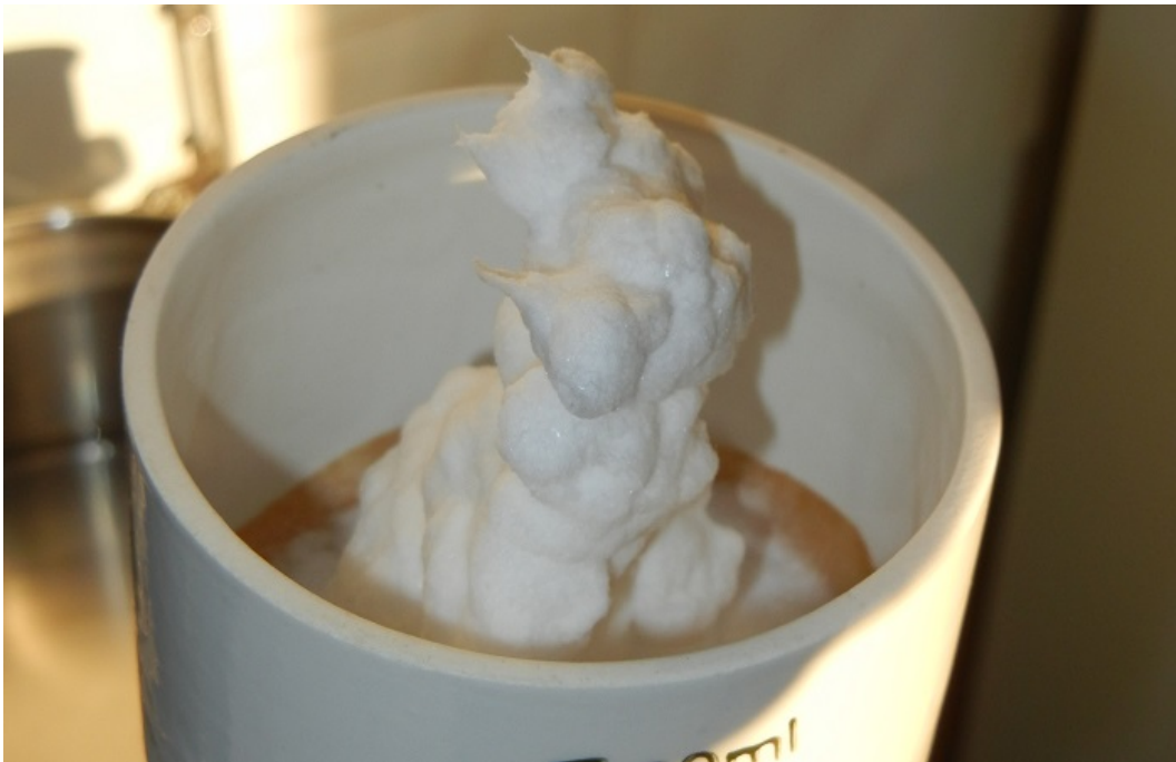
Beim Filtrieren verkanteten sich die Kristalle zu einer filzartigen Masse und bilden so einen Turm, den man zum leichteren Waschen flachdrücken sollte.
