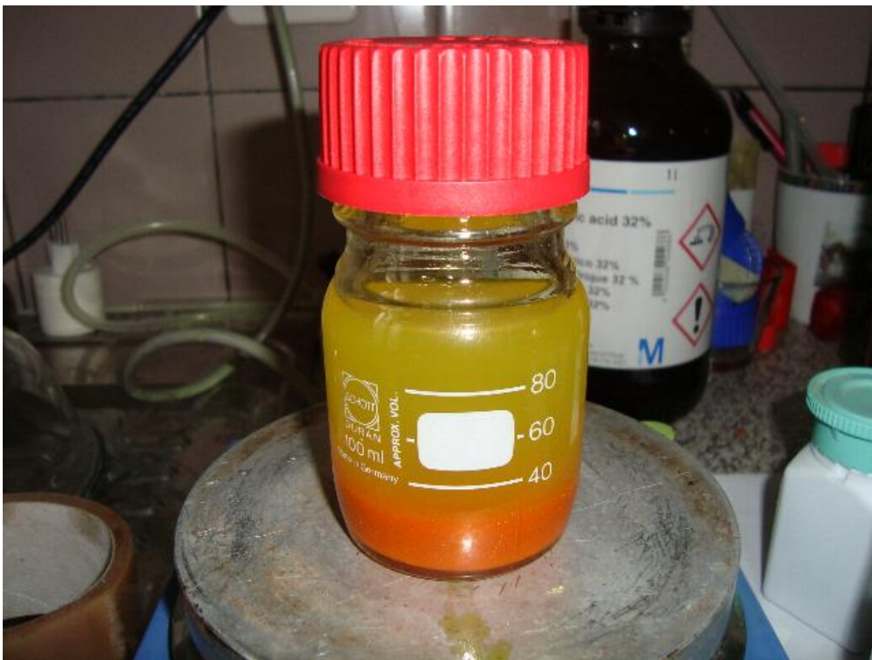
Mit Ethanol ausgefälltes Ammoniumhexacyanoferrat(III)
