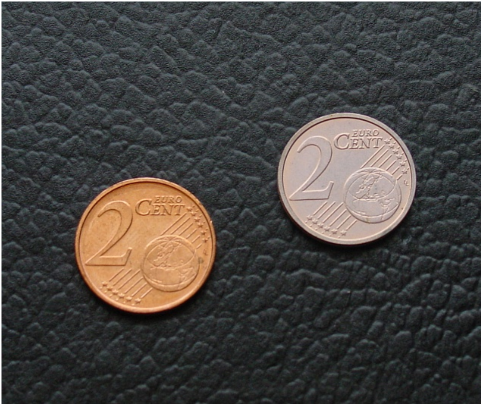
Verquickte Münze nach 4 Tagen Lagerung: das Kupfer schimmer wieder durch
