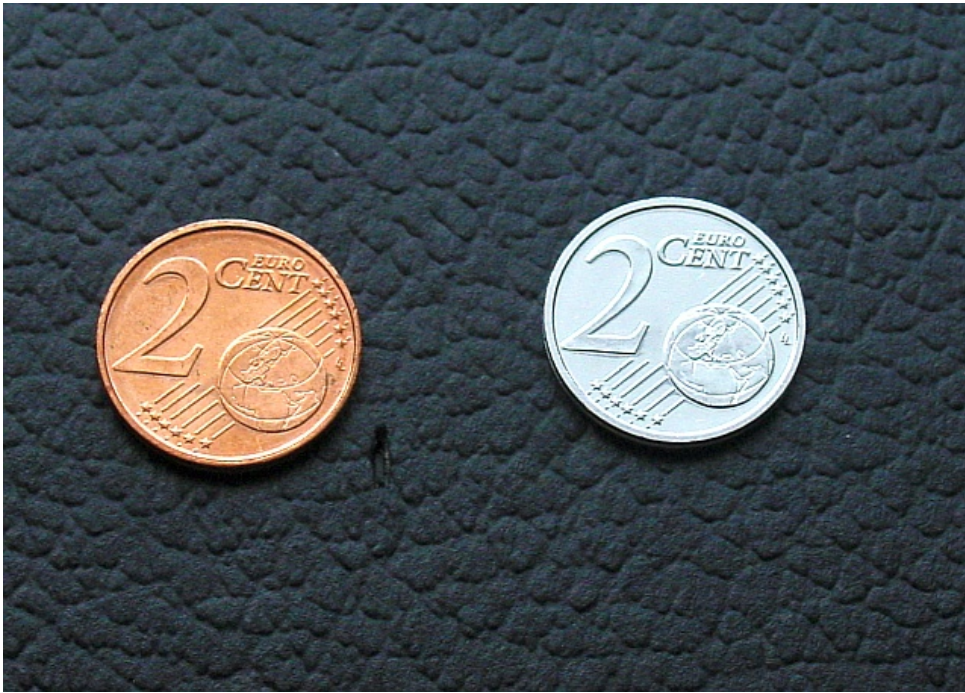
Verquickte Münze (rechts) im Vergleich mit unbehandelter Münze
