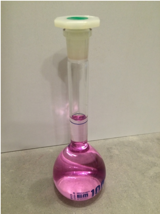
Die vorbereitete Probenlösung im Messkolben, gerade schwach rosa eingestellt
