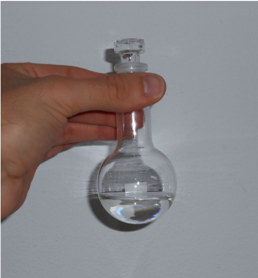
Gewonnener Acetessigsäureethylester nach der Destillation
