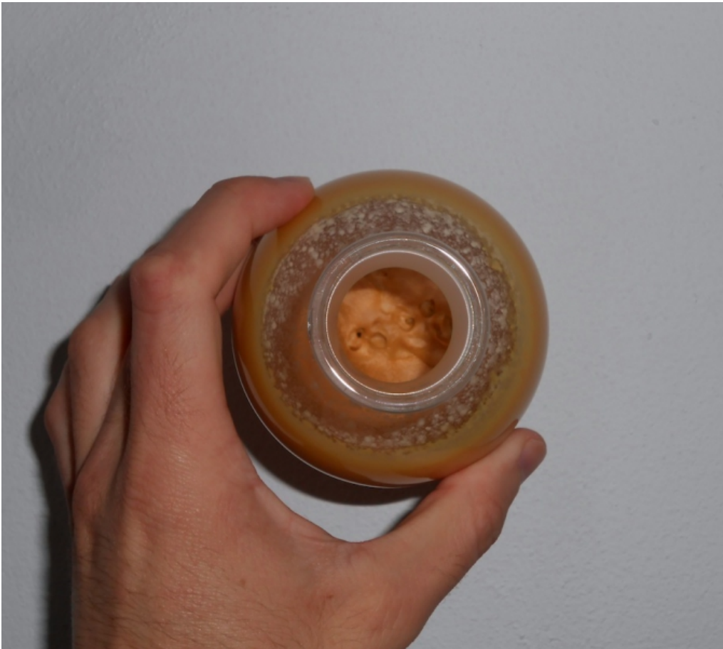
Feste Masse nach Entfernung überschüssigen Ethylacetats
