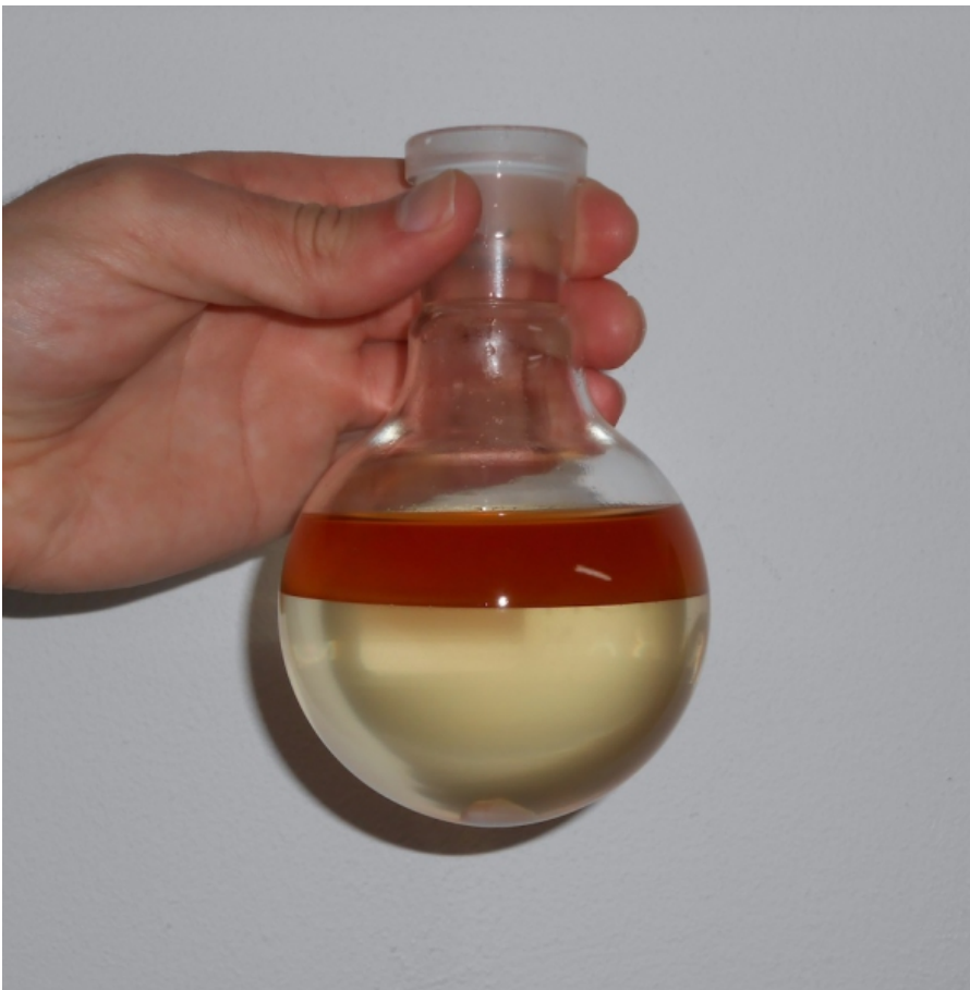
Nach Versetzen mit Schwefelsäure scheidet sich Acetessigsäureethylester ab (zusammen mit restlichem Ethylacetat).
